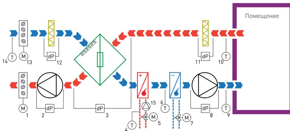
**1, 13** — Электропривод воздушной заслонки (24В или 230В); **2, 8** — Дифференциальное реле давления (контроль работы вентилятора); **3** — Дифференциальное реле давления (контроль обмерзания рекуператора);
